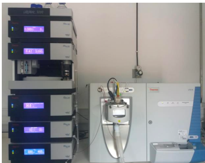
Figura 10. Sistema cromatográfico HPLC-DAD-ESI/MS utilizado na caracterização do perfil individual de compostos fenólicos.
