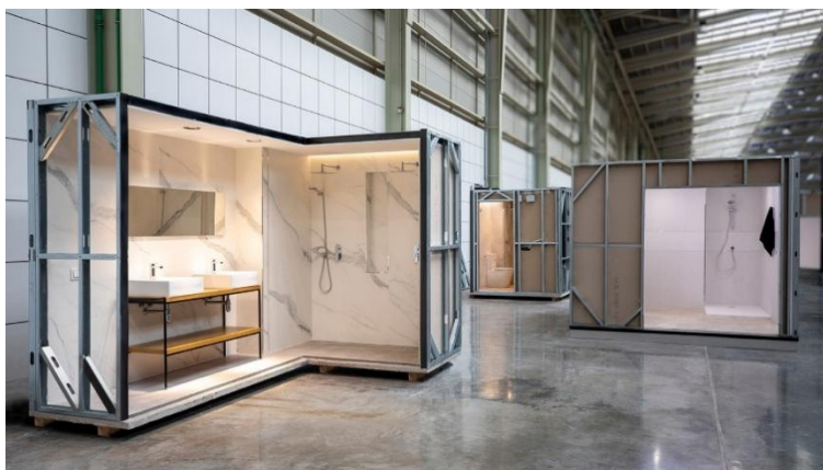
Figura 34: Produção industrializada de módulos sanitários em ambiente controlado.
