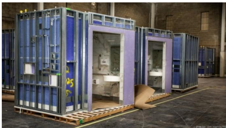
Figura 26: Unidade sanitária modular técnica especializada produzida em ambiente fabril
