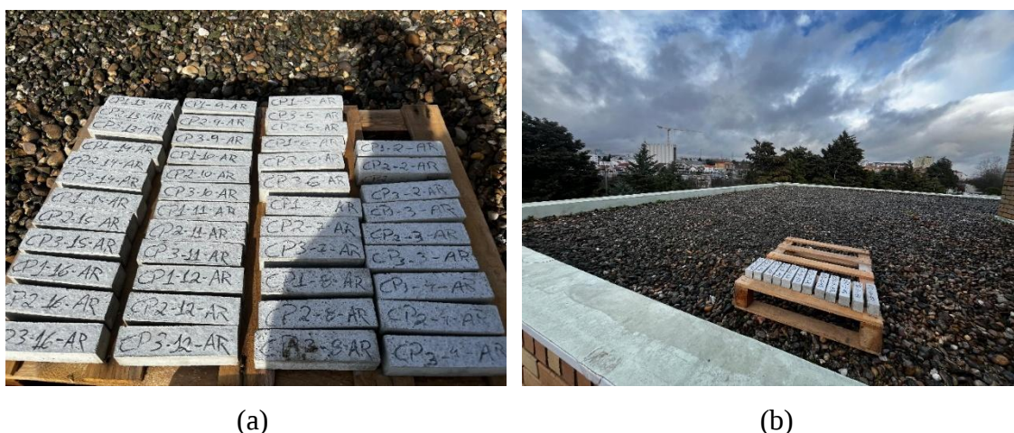
Figura 9 - Disposição dos corpos de prova em ambiente externo.
