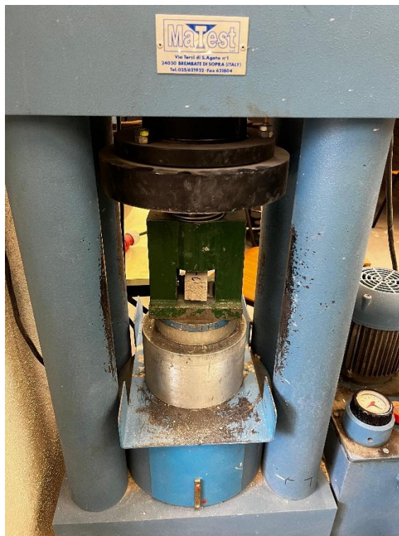
Figura 14 - Corpo de prova submetido ao ensaio de resistência à compressão.
