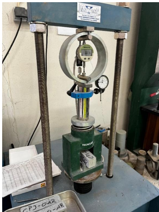
Figura 13 - Corpo de prova submetido ao ensaio de resistência à flexão.
