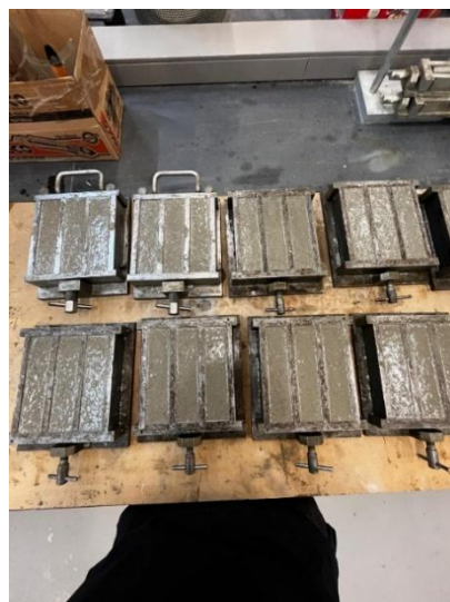
Figura 5 - Moldagem do corpo de prova.
