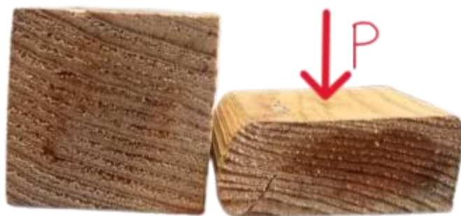
Figura 32. Deformação de provete cúbico devido ao efeito de confinamento.
