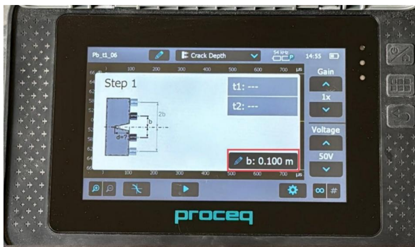
Figura 24: Tela com a orientação para estimar a profundidade de fendas.
