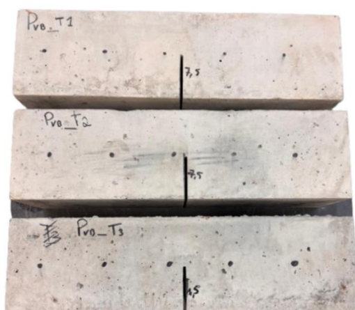
Figura 18. Corte transversal nas vigas de betão.
