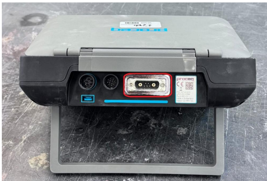
Figura 4: Zona de conexão dos cabos.
