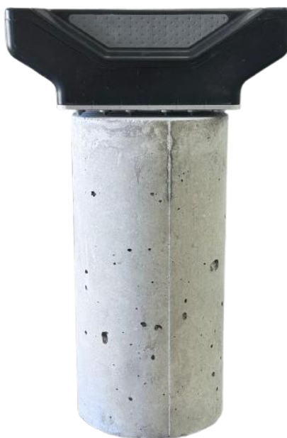
Figura 29: Exemplificação de medição de pulso eco em cilindro.
