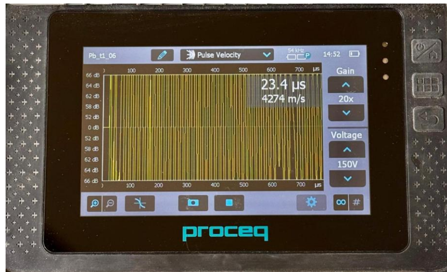
Figura 15: Tela de medição de velocidade de pulso com ganho e voltagem elevados.
