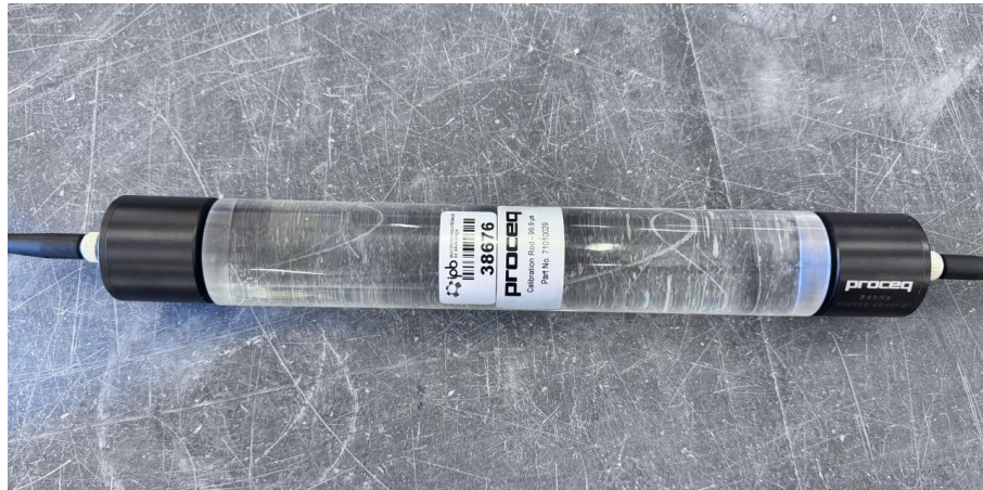
Figura 12: Exemplificação de acoplagem dos transdutores no bastão de calibração.
