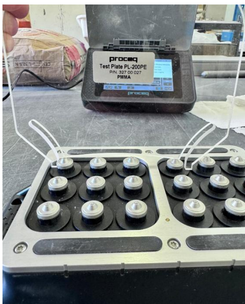
Figura 28: Exemplificação da posição da placa de calibração no transdutor tipo scanner.
