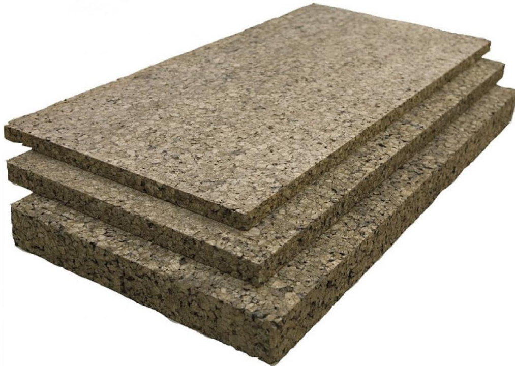
Figura 2; Estrutura do Aglomerado de Cortiça Expandida (ICB), evidenciando as células fechadas responsáveis pelo isolamento (Unicorstudio,2025)
