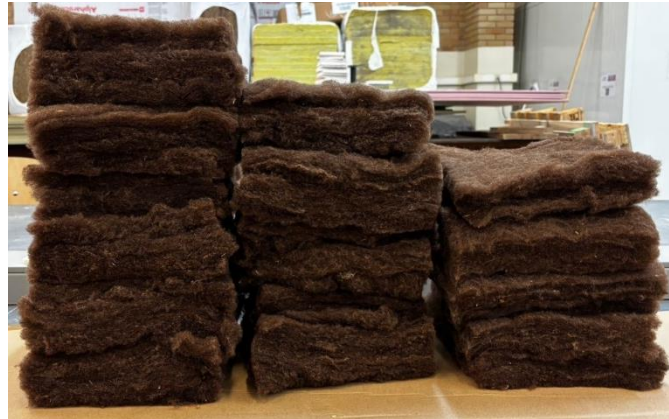
Figura 12: Amostra preliminar da primeira etapa após a cura, evidenciando baixa rigidez e elevada maleabilidade
