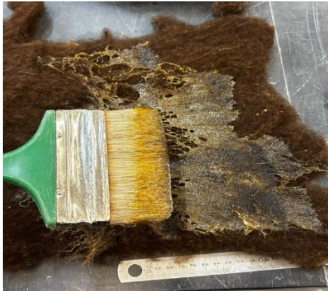
Figura 11: Manta de lã sendo impregnada com resina natural de pinheiro diluída com óleo de linhaça usando pincel.
