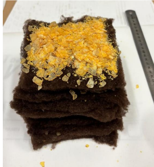
Figura 19: Montagem das camadas de lã, evidenciando a distribuição uniforme do aglutinante e a ausência de aditivos líquidos.
