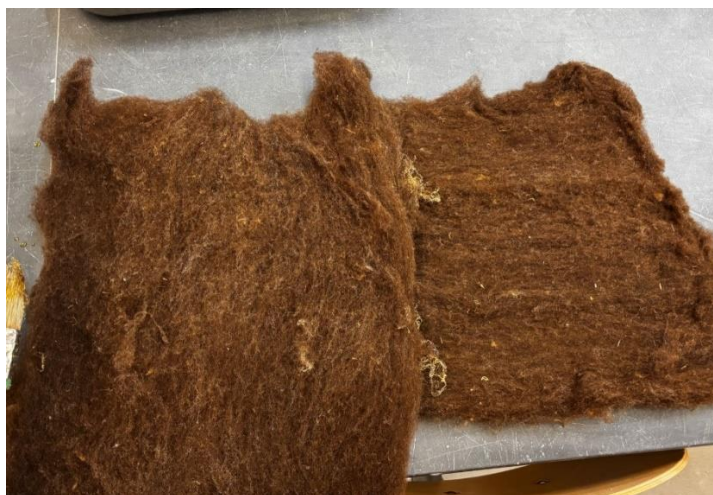
Figura 10: Organização ortogonal das camadas de lã utilizando a técnica de cross-lapping
