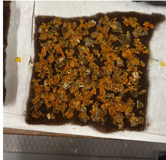
Figura 17: Distribuição da resina granulada sobre a manta de lã antes da prensagem.
